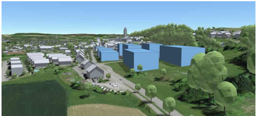
Visualisierung der maximal möglichen Bauvolumen in der Industriezone Bollerrain gemäss BZO-Entwurf (Fassadenhöhen von 13 m in 1. Bautiefe und 20 m im rückwärtigen Bereich)
