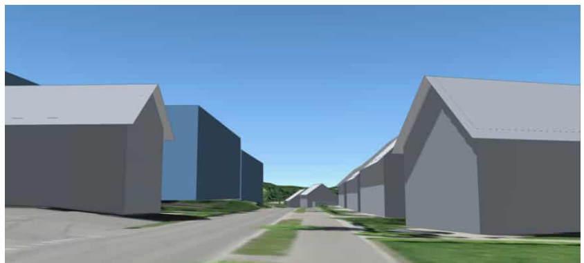
Visualisierung der maximal möglichen Bauvolumen in der Industriezone Bollerrain gemäss BZO-Entwurf (Fassadenhöhen von 13 m in 1. Bautiefe und 20 m im rückwärtigen Bereich, Fussgängerperspektive)
